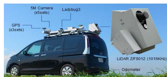
図-2 計測車両(三菱製 MMS-X500ZL)
