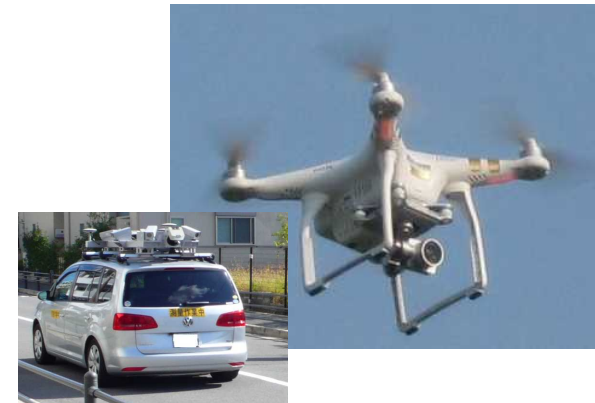
レーザ測量等に加え、ドローンによる3次元測量も可能に
