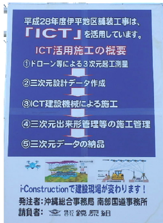
工事看板によるICT活用 工事をPR
