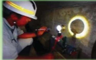
揚圧力観測状況
