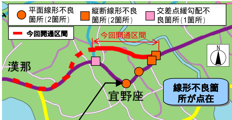
平面不良かつ視距不足箇所
