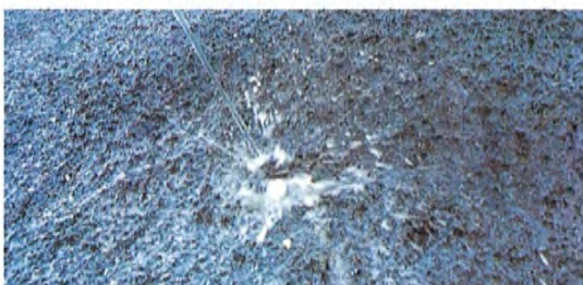
鉄砲水をかけても水を弾きますが、土壌内部からの水に対しては放出する性質もっています。これが耐水性にすぐれているEMNコート21Rの特徴です。
