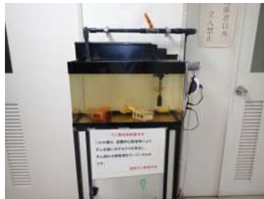
水質監視用の魚水槽(漢那ダム管理支所)
