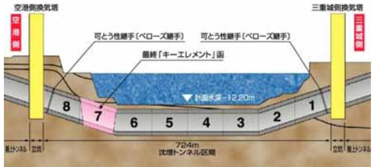
図 - 4 沈埋トンネル縦断面図
