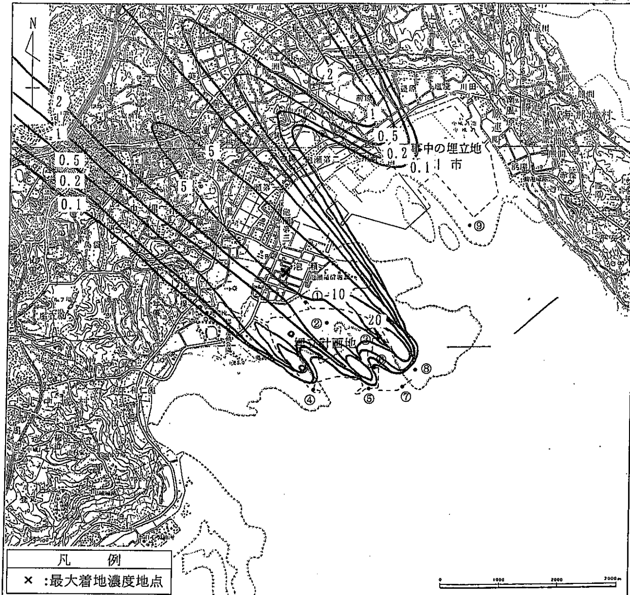
図-1(3) 工事中の大気拡散予測結果(南東風条件, 一酸化炭素の日平均値)
