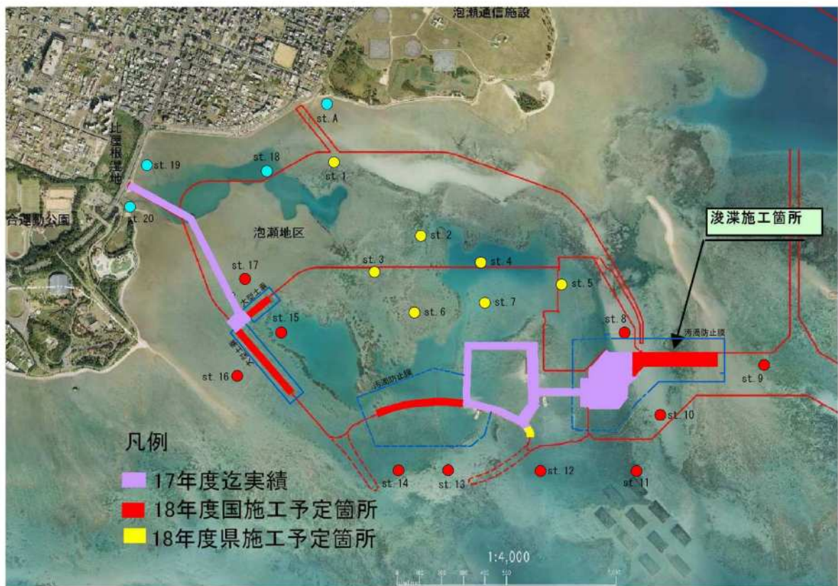
仮設橋梁側からの工事および海上工事の濁り監視地点
