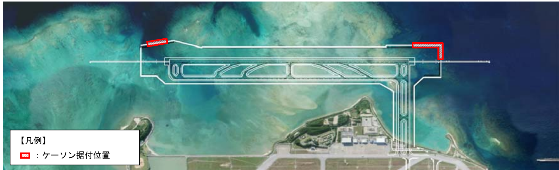
図 6 護岸工事（ケーソン据付）の実施位置
