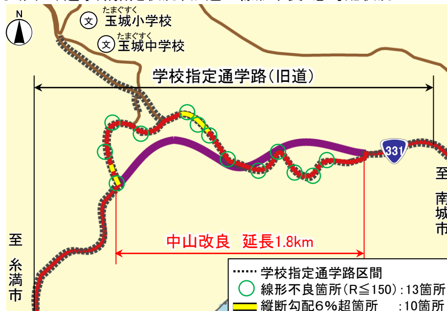
● (図19) 通学路指定状況、旧道の線形不良・急勾配状況
