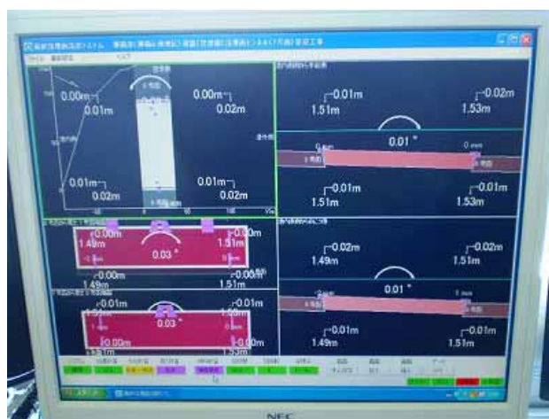
写真 - 5 GPS位置監視システムモニター
