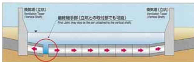
図 - 3 最終継手概念図
