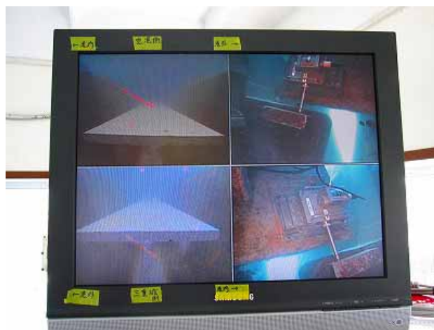
写真 - 4 監視用カメラモニター（右側は函体貫入距離計）
