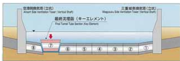
図 - 4 本工事における最終継手位置図
