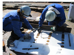
図-4 ウェブ板厚測定状況
