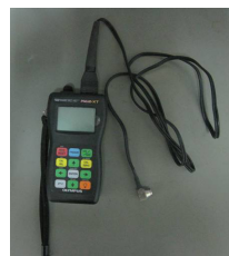
図-3 超音波厚さ計 (5MHz)
