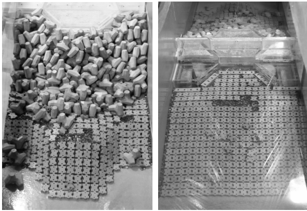
(a) 港外側 (b) 港内側 図-17 ブロック安定実験の波作用後の状況
