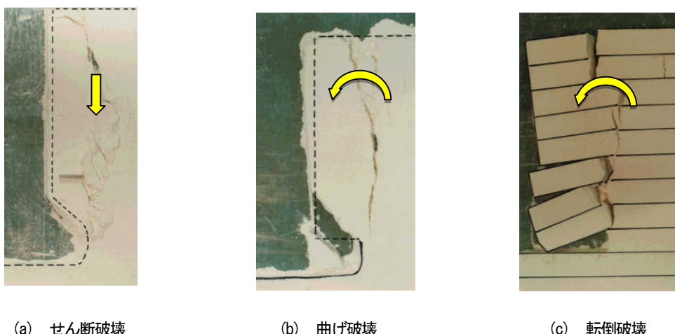
図-8 底面摩擦模型実験によるオーバーハング崖の崩壊形態
