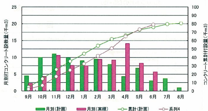
図-10 コンクリートの打設実績
