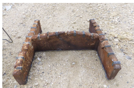
超硬ビット破損状況
