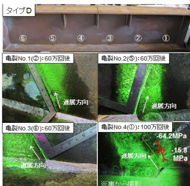
写真5 タイプD 発生亀裂一例
