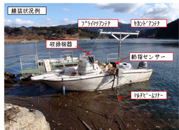
写-2 マルチビーム調査船の機装状況例
