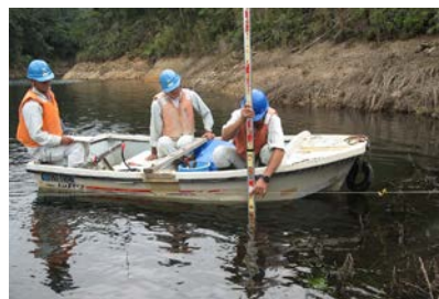
写-1 ロットを用いた浅所部の測定作業
