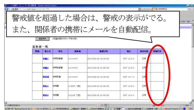
図-2 監視HP画面(伸縮計、雨量計、傾斜計)
