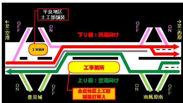
図-4 ステップ1：下り線側への走行車線切替
