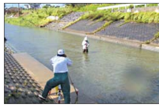
流量観測: 洪水時等の対応時に必要な下流河川の流量を調査し、河川水位と流量の関係を整理します。
