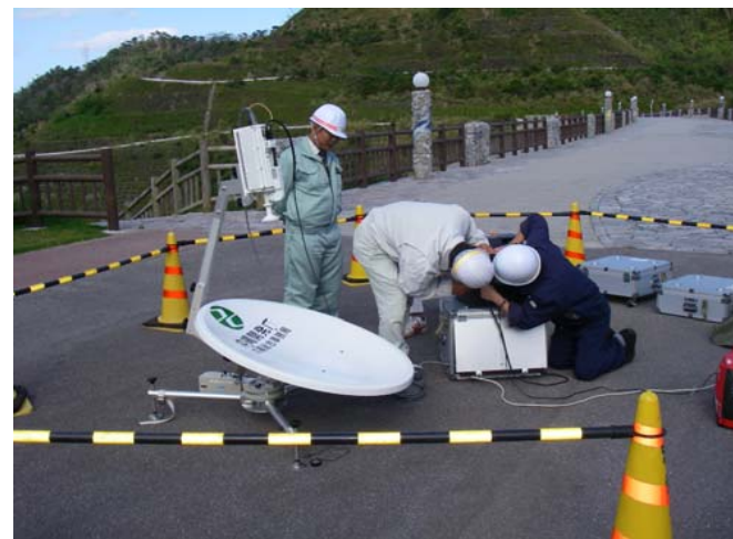
○OKu—SAT(衛星小型画像伝送装置)の設置、通信訓練
