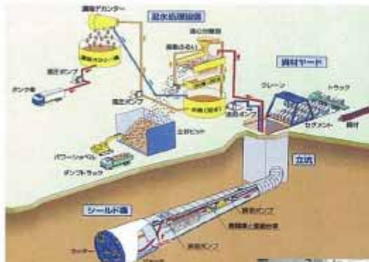
汚泥処理設備概要
