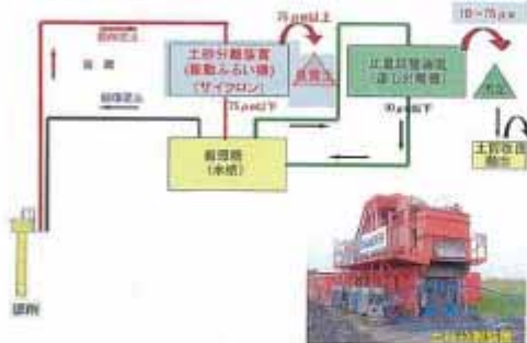
土砂分級及び建設汚泥搬出システムの概要(一般的分級)
