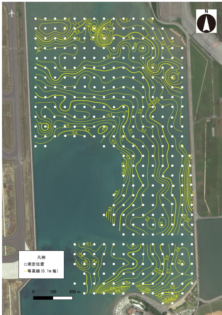
図－ 1.4.32 測定位置及び地盤高
