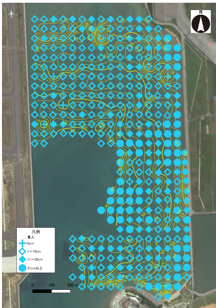
図－ 1.4.34 砂層厚の測定結果
