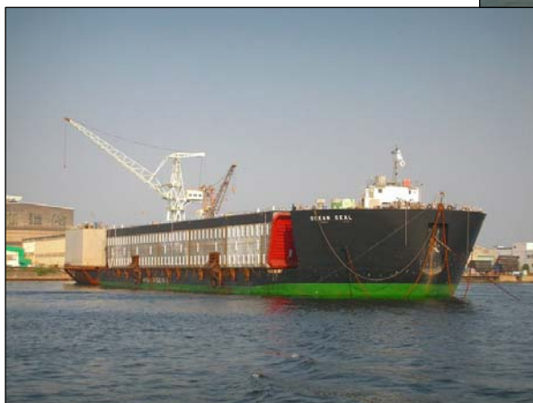
鋼殻積込完了状況
