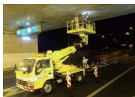
トンネル点検車
