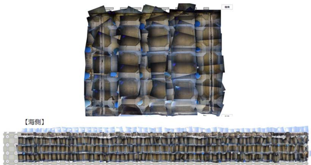
写真から作成した上部工下面の展開図
