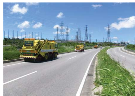
【路面清掃車による清掃】
