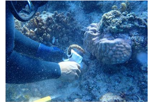
図 69 水温調査（水温計回収・設置）状況
