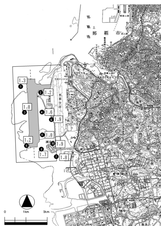
図－ 6.2.71 (5) COD（化学的酸素要求量）の水平分布
