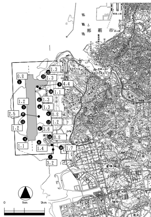
図－ 6.2.73 (5) COD（化学的酸素要求量）の水平分布
