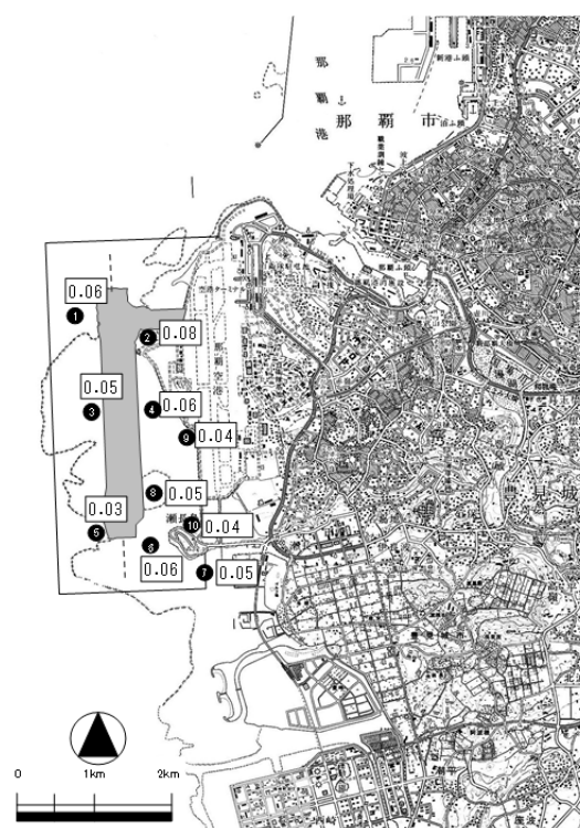
図－ 6.2.71(6) T-N（全窒素）の水平分布
