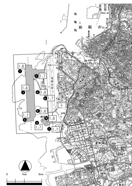
図－ 6.2.71 (5) COD（化学的酸素要求量）の水平分布
