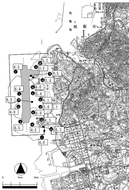
図－ 6.2.73 (3) 強熱減量の水平分布
