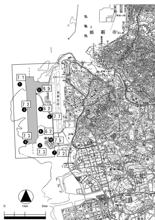
図－ 6.2.71 (2) DO（溶存酸素量）の水平分布
