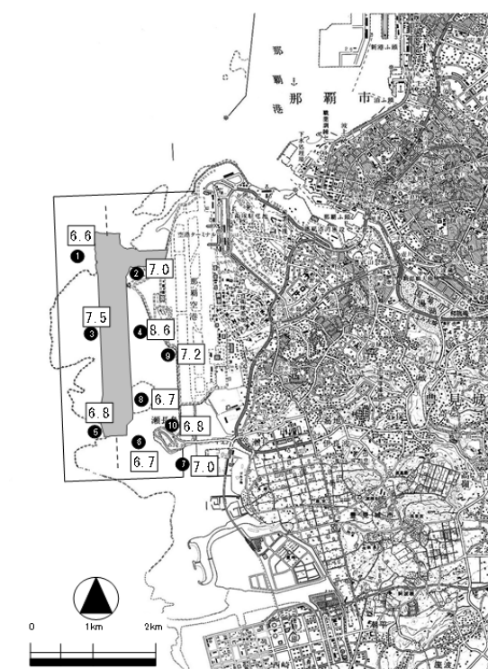
図－ 6.2.71 (2) DO（溶存酸素量）の水平分布
