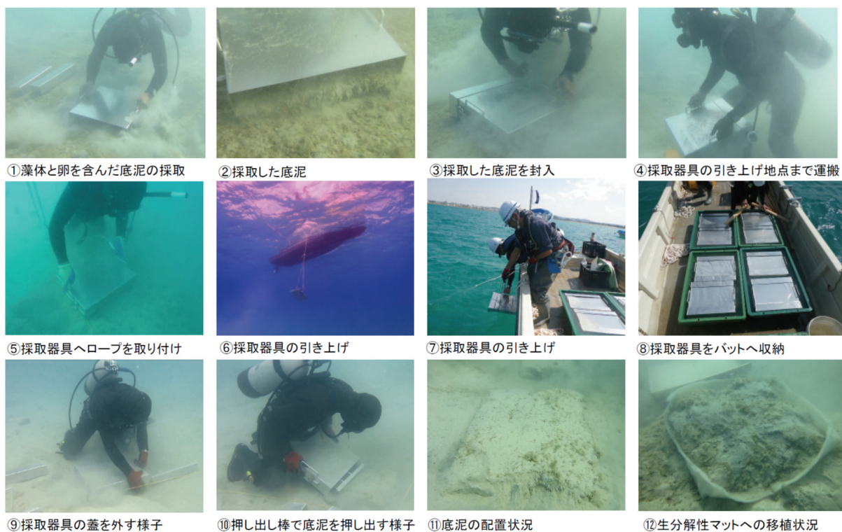
図ー 4.2.69 クビレミドロの移植方法
