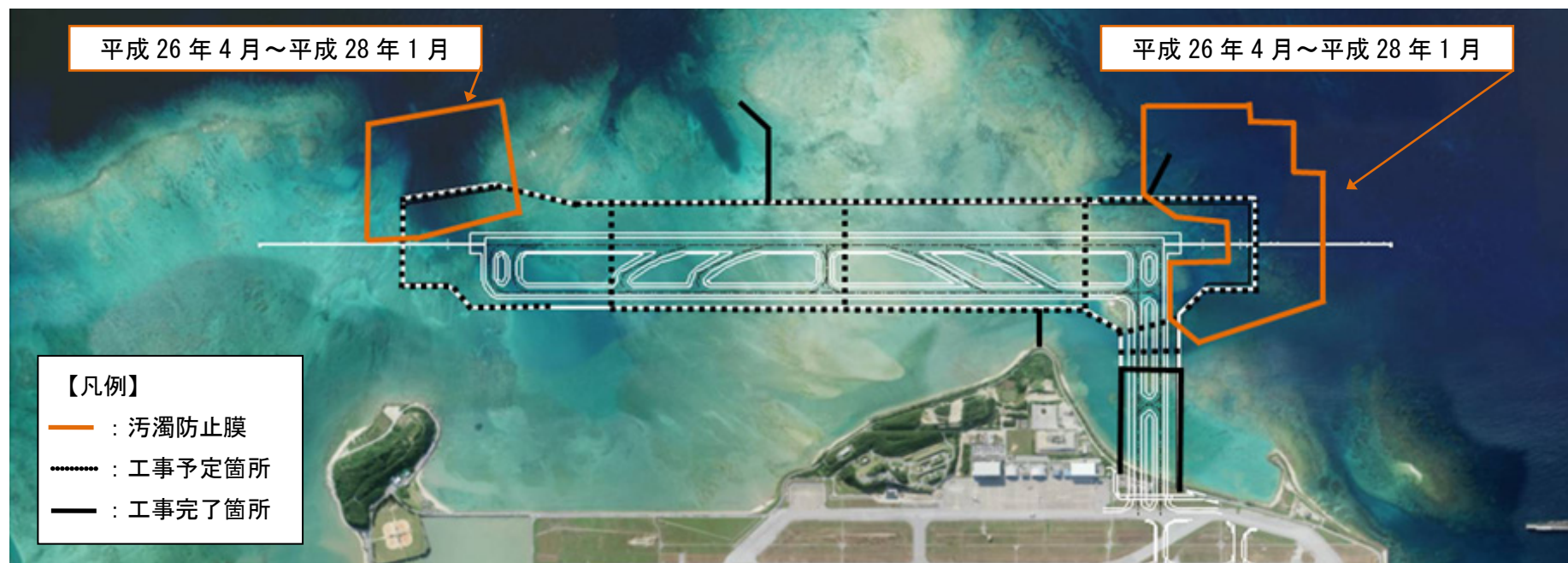
図 2 汚濁防止膜の設置位置
