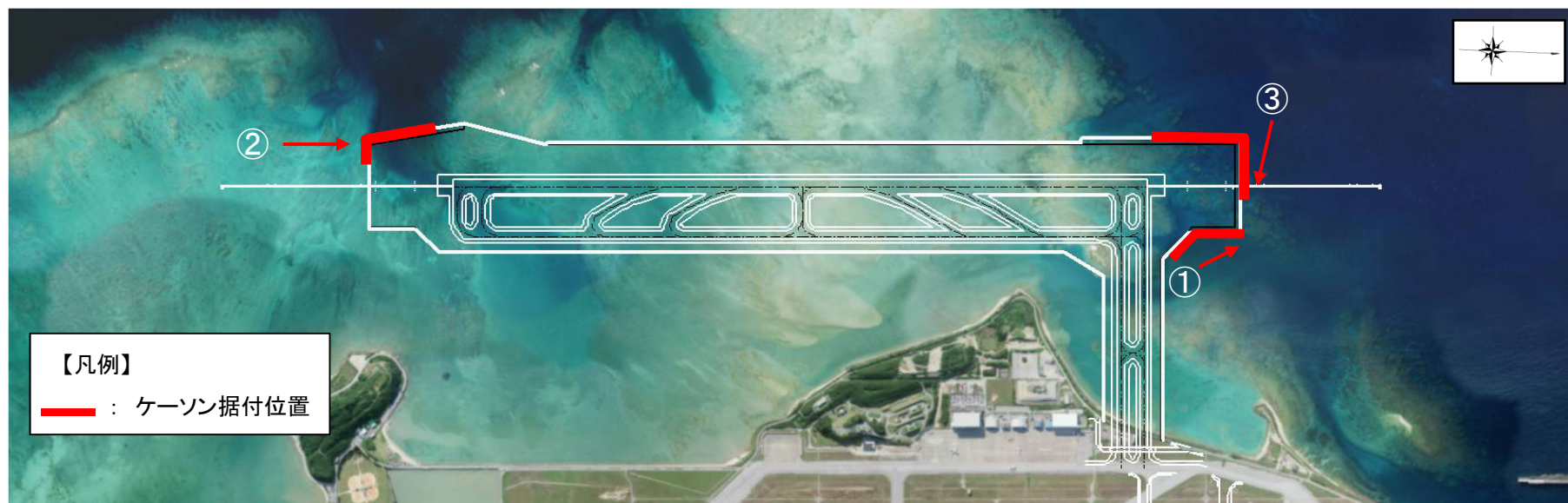
図6 護岸工事(ケーソン据付)の実施位置
