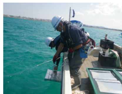
採取器具を海水を満たしたバットに引き揚げ・収納
