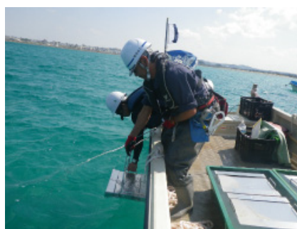
採取器具を海水で満たしたバットに 引き揚げ
