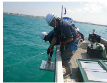
採取器具を海水で満たしたバットに引き揚げ・収納
