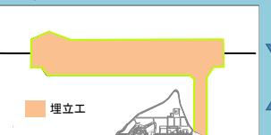
②護岸の内側に土砂を投入し埋立をします。
