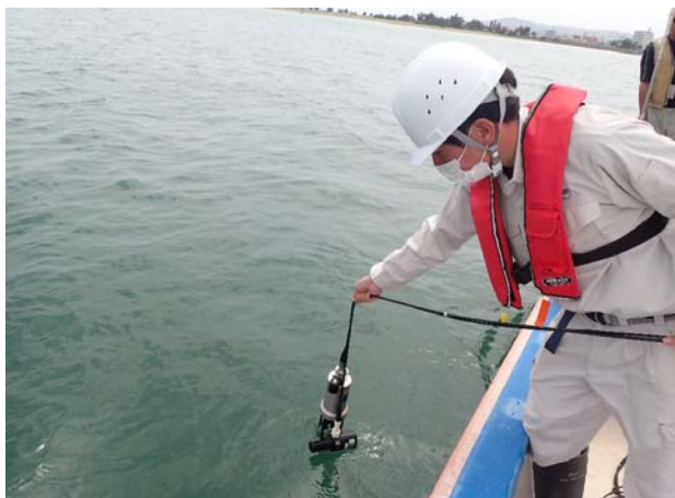
■工事箇所の濁り監視 海上 (国施工)
