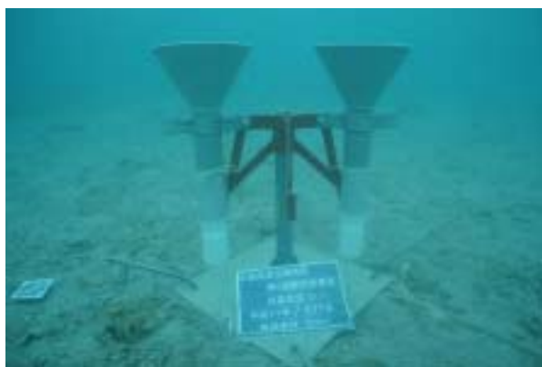
写真-2.1 セディメントトラップ設置状況
