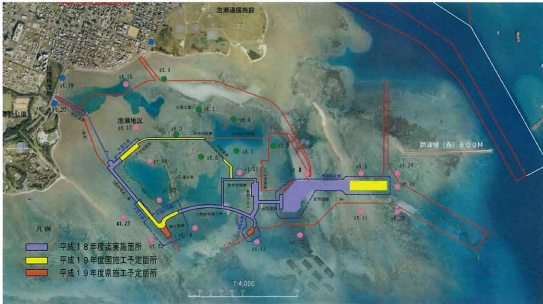
仮設橋梁側からの工事および海上工事の濁り監視地点
