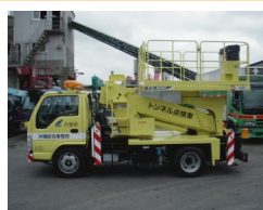
トンネル点検車
