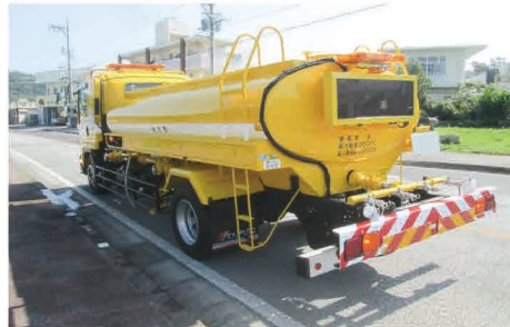
散水車（給水設置付き）
