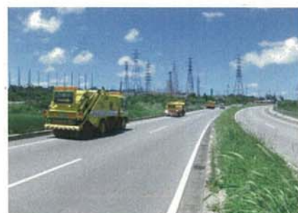
【路面清掃車による清掃】
