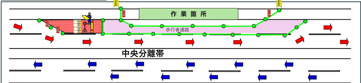
交通規制図(上下線規制時)
