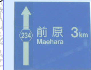
No.1: 確認案内標識
